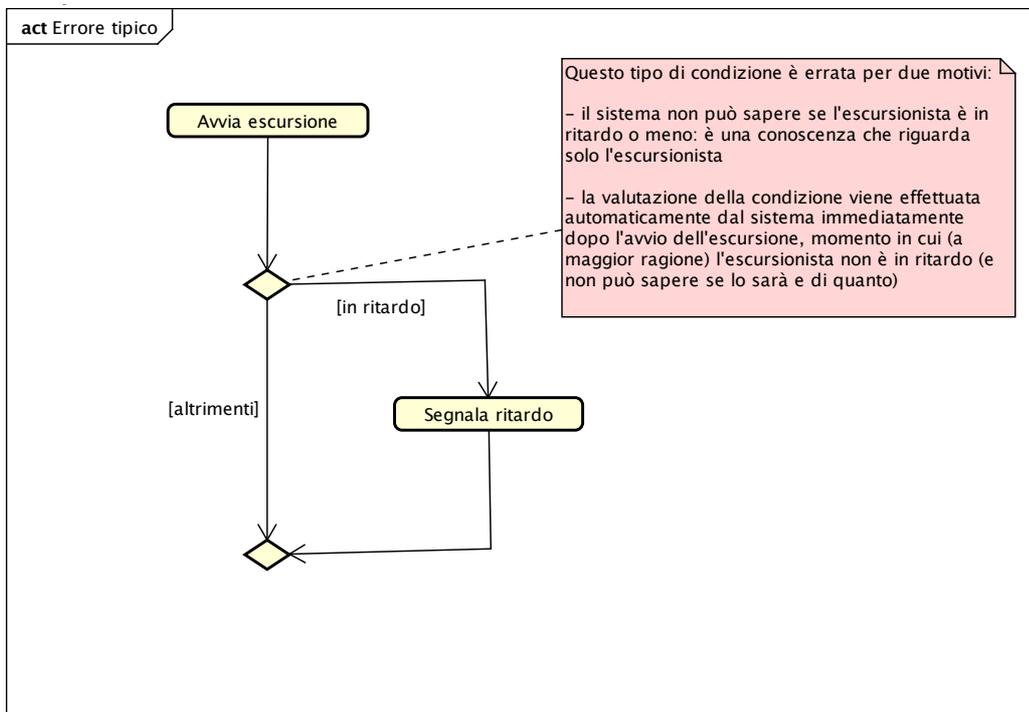
Il seguente frammento di processo costituisce un altro errore che indica una mancata comprensione di come sono gestiti i segnali (automaticamente dal sistema)
