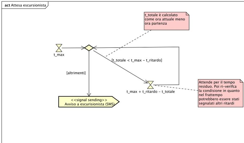
Attenzione: il seguente tipo di soluzione costituisce un errore particolarmente grave perché indica una mancata comprensione del funzionamento del costrutto di scelta/condizione.
